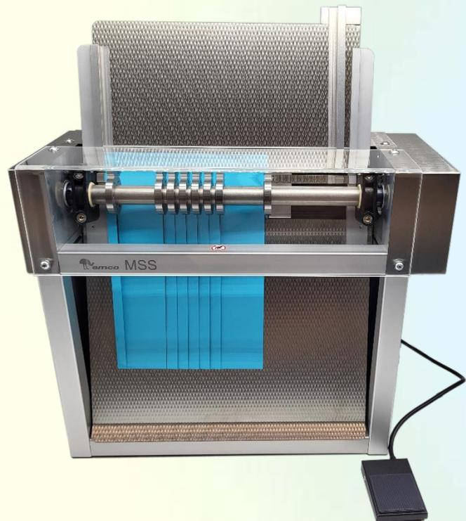
Das Gerät ist als Einzelblattschneider konzipiert. Der Probefbogen wird auf das Einlaufblech gelegt und über die Messer senkrecht ausgerichtet. Beim Betätigen des Fußschalters wird der Probefbogen erfasst, eingezogen und die Streifen werden geschnitten. Die Rundmesser und der Papiereinzug sind mit einem Berührungsschutz aus durchsichtigem Kunststoff versehen.
